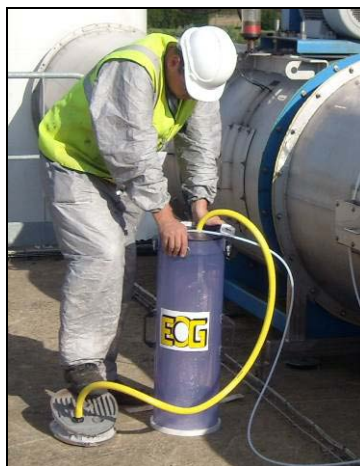
Photo 1 : « Lung casing » type sampling system
